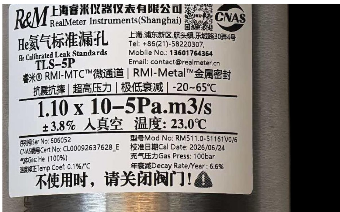
图 5 睿米（RealMeter Instruments）TLS-5P 有源氦气标准漏孔实物标签：年衰减率 6.6%/年为按气室参数（1000 mL @ 100 bar）取两模型从严上限的标注值；元件处于过渡流态、含分子流成分，实际衰减介于 3.4%~6.5% 之间，低于标注值
