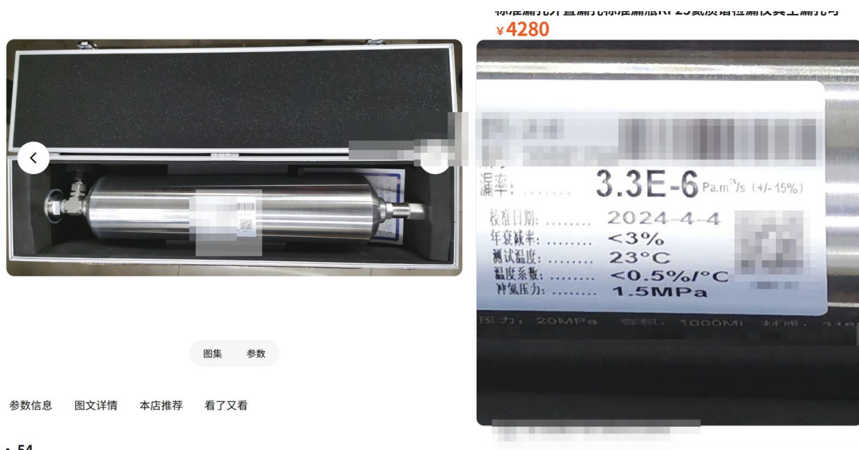
图 4 某电商平台在售标准漏孔的实物标签（型号、编号、条码、二维码及瓶体序列号已像素化脱敏）：漏率 3.3 \times 10^{-6} Pa·m 3 /s（ \pm 15\% ）、冲氮压力 1.5 MPa、年衰减率 <3% 同时印在一张标签上；瓶体刻字可见容积 1000 mL、额定压力 20 MPa
